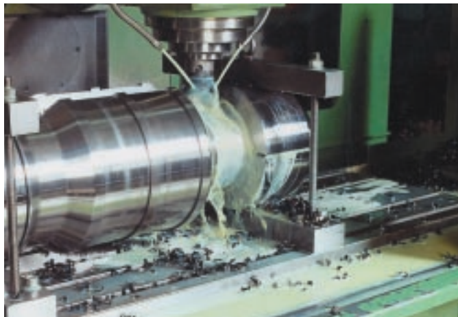
Mit einer Toleranz von nur 0,05 mm lassen sich einmal aufgespannte Werkstücke äußerst präzise fräsen und bohren.
