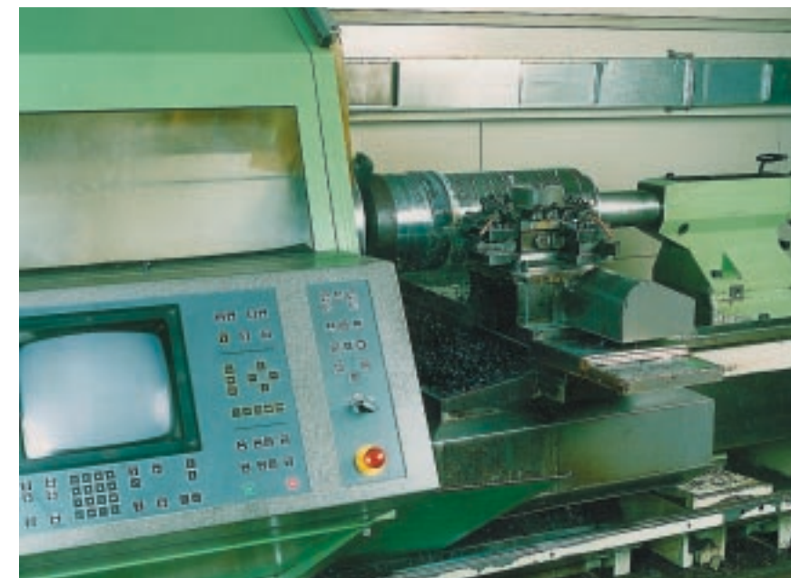
Bearbeitung eines GRUNDORAM-Kolbens auf der Drehbank.
