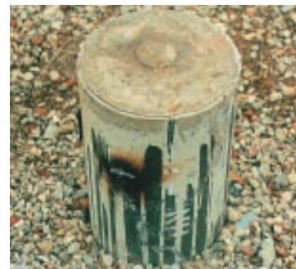
Das bereits vorgetriebene und mit hoch- wertigem Injektionsmörtel vergossene Stahlrohr.
