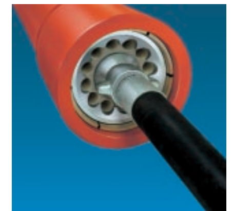
Die Ramme kommt ohne sonst übliche Gewindeverbindung aus.
