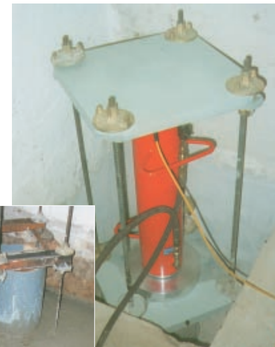
Die Pfahlgründung am praktischen Objekt im Keller eines Hauses. Das Bild daneben zeigt die hydraulische Presse.
