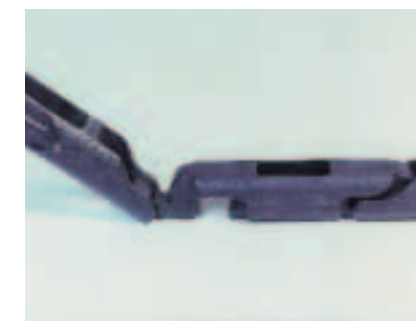
Das Zuggestänge wird nicht verschraubt sondern nur eingeklinkt.
