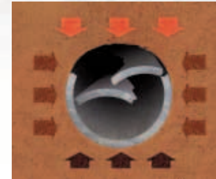
Bruch eines biegesteifen Rohrmaterials (Quelle: ATV 1999).
