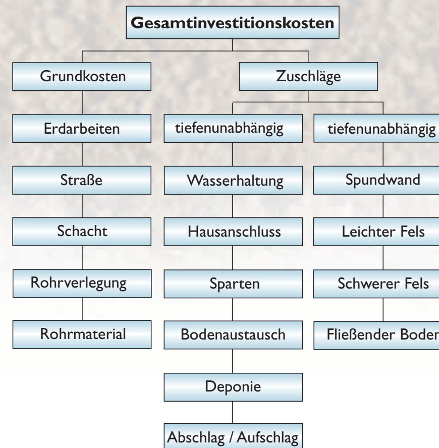
Zusammensetzung der Investitionskosten einer Kanalbaumaßnahme.
