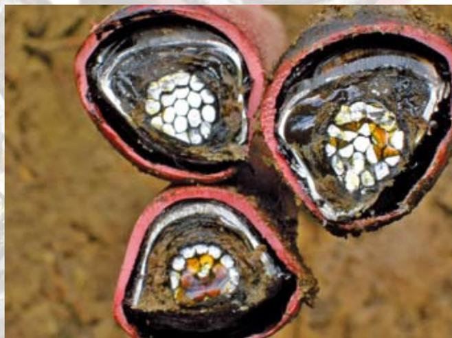
Querschnitt des zu überbohrenden 10 kV-Altkabels.
