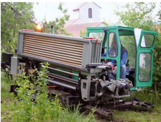
GRUNDODRILL-Bohrgerät hat sich an der Hangkante oberhalb des unbebauten Grundstücks für den Überbohreinsatz positioniert.
